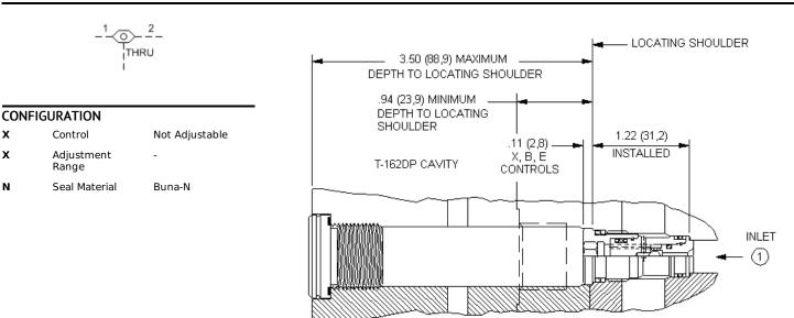
CAPACITY: 4,7 L/min. | CAVITY: T-162DP
