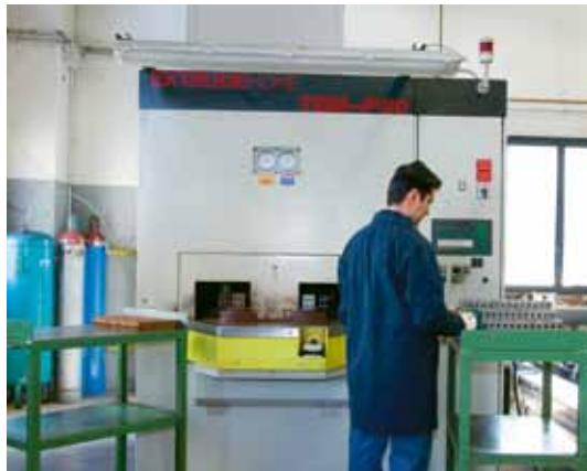
Dal 2003 l'Oleodinamica Marchesini può vantare la presenza di un moderno impianto di sbavatura termica **TEM** a cui sottopone tutti i corpi valvola prima di essere inviati al trattamento di zincatura.
