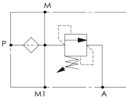
Valvola limitatrice di pressione con tenuta ad otturatore, con funzione di protezione del circuito da sovrappressioni accidentali. Provvista di filtro all'ingresso.
